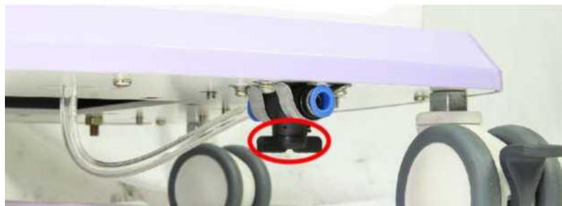
Рисунок 27. Удаление конденсата воздушного компрессора
