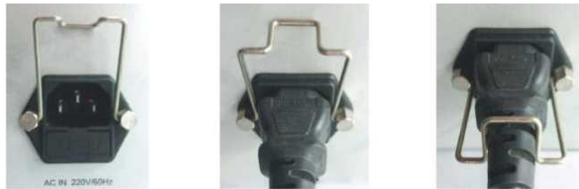
Рисунок 3. Подключение кабеля питания
