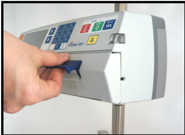
Открытие внешних дверок: поднимите фиксатор вверх и затем потяните дверцу.
