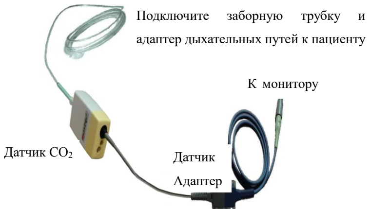
Рис. 16-4. Схема подключения Masimo CO 2 для анализатора ISA™ бокового потока
