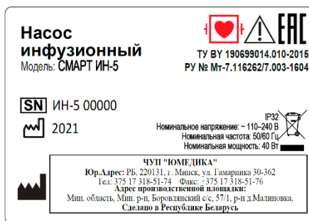
Рис. 1. Пример маркировки насоса инфузионного СМАРТ ИН-5
