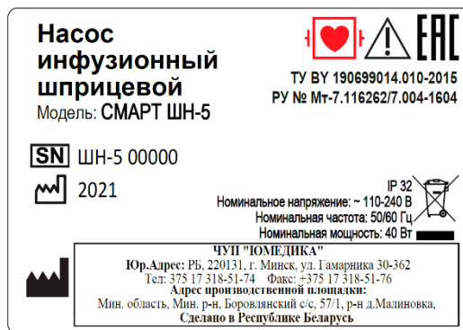
Рис. 3. Пример маркировки насоса инфузионного шприцевого СМАРТ ШН-5
