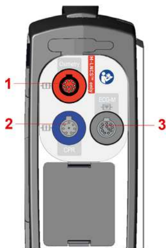
Рисунок 5-4 Интерфейсы на правой стороне прибора (с одноразовым датчиком corPatch СЛР)
