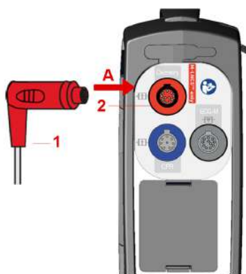
Рисунок 10-6 Подключение датчика пульсовой оксиметрии (на изображении: правая сторона прибора с corPatch СЛР)
