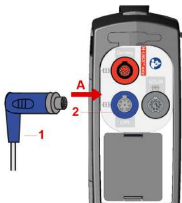
Рисунок 11-12 Присоединение одноразового датчика corPatch СЛР
