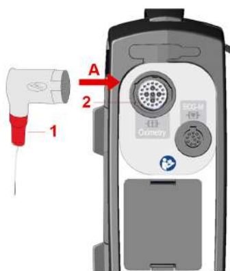
Рисунок 10-5 Подключение датчика пульсовой оксиметрии (на изображении: правая сторона прибора без corPatch СЛР)
