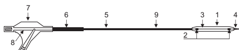
Фигура - 1 схема на Балонен катетър с РТА водач и покритие от сиролимус (0,014" OTW, 0,018" OTW, 0,035" OTW)
