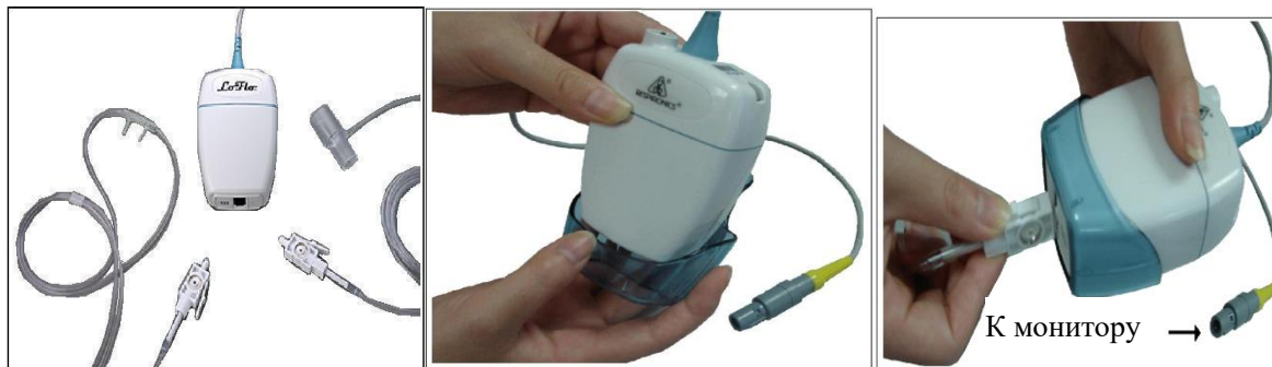
Рис.17-5. Схема подключения газоанализатора Respironics CO 2 в боковом потоке
