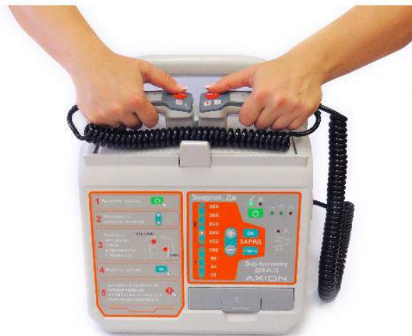
Рисунок 23 – Проведение тестового разряда
