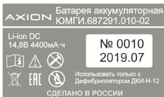
Рисунок 9 – Этикетка на аккумуляторной батарее
