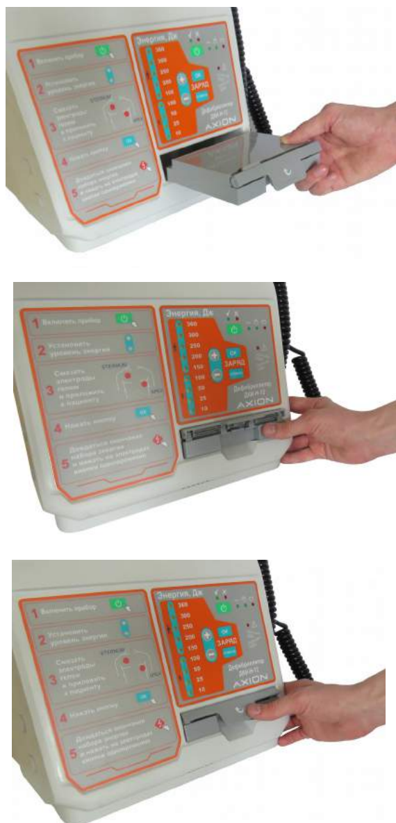
Рисунок 16 – Установка аккумуляторной батареи
