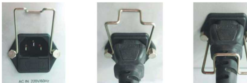
Рисунок 1. Подключение кабеля питания
