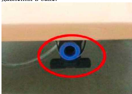
Рисунок 35. Удаление конденсата воздушного компрессора
