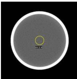
Рис. 15-6. Измерение значения СТ водяного фантома с использованием протокола STD QA головки
