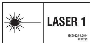
Рисунок 8.1 Этикетка прибора, имеющего лазер класса 1
