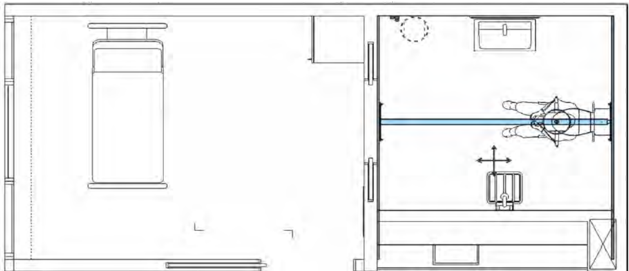
Рисунок 3.2 – Система для подъема и перемещения пациентов рельсовая (потолочная, настенная) медицинская «ОРТОРЕНТ ПРМ-01». Вариант установки в одной комнате. Вид сверху. Настенная установка
