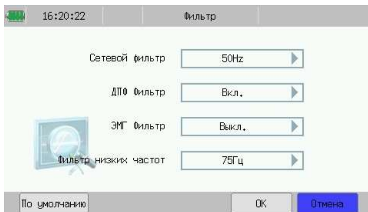
рис. 4-10: установка фильтра Вы
