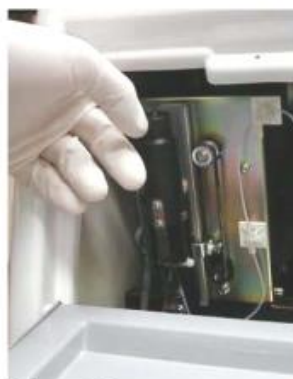
Фото 28 Потяните на себя узел поршня, чтобы удерживающие магниты высвободили узел.
