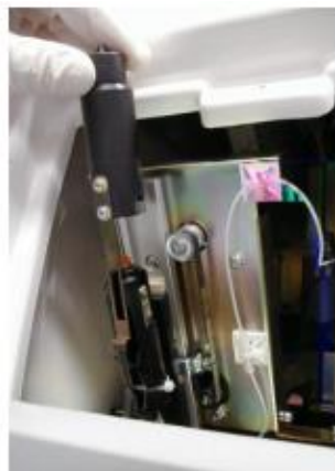
Фото 31 Вставьте поршень, наблюдая за его металлической защелкой, которая должна выпасть перед вами.
