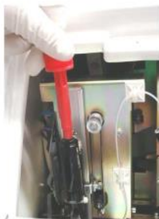
Фото 30 Замените иглу с помощью красного или зеленого инструмента, затягивая новую иглу не прилагая избыточного усилия во избежание приложения пластиковой резьбовой части.
