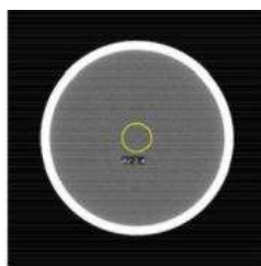
Рис.12-5 Измерение КТ-значения водного фантома с использованием протокола Head STD-QA
