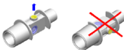
Рисунок 2.53 – Положение IRMA адаптера воздуховода
