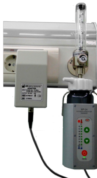
Рис. 3. Увлажнитель кислорода прямого включения с модулем нагрева УВПК-ИМТ-01-МН
