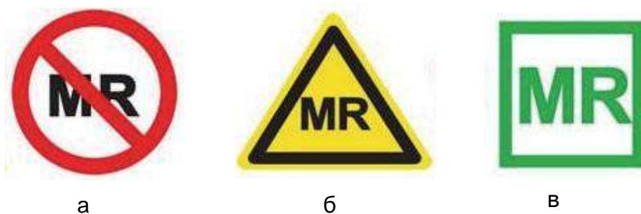
Рис. 2-3 Знак безопасности оборудования МРТ
