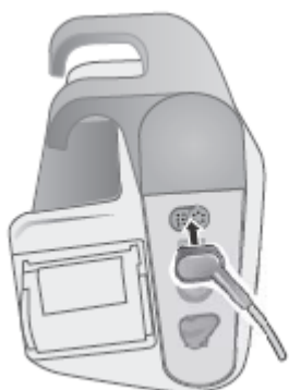
Рисунок 6-3 Подключение ЭКГ кабеля к прибору X Series
