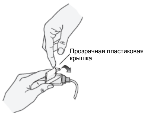
Рисунок 10-2 Опустите пластиковую крышку для фиксации соединения
