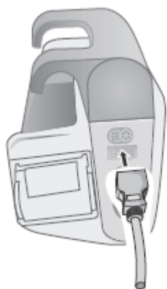
Рисунок 10-3 Подсоединение датчика SpO 2 к прибору X Series
