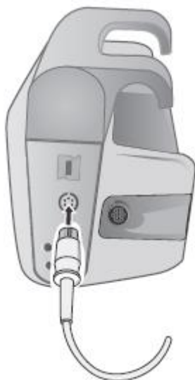
Рисунок 11-1 Подключение датчика к прибору X Series
