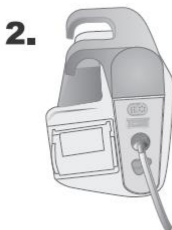
Рисунок 8-1 Подсоединение двухпросветной трубки к прибору X Series
