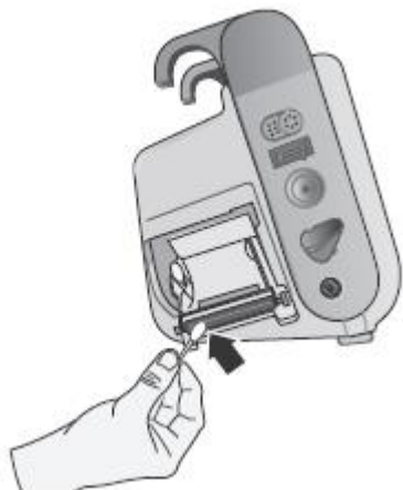
Рисунок 24-3. Очистка печатающей головки
