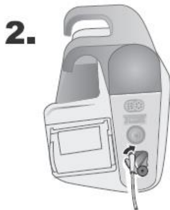
Рисунок 10-1 Подсоединение наконечника магистрали для отбора проб к входному порту CO 2
