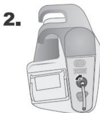
Рисунок 8-2 Подсоединение однопросветной трубки к прибору X Series
