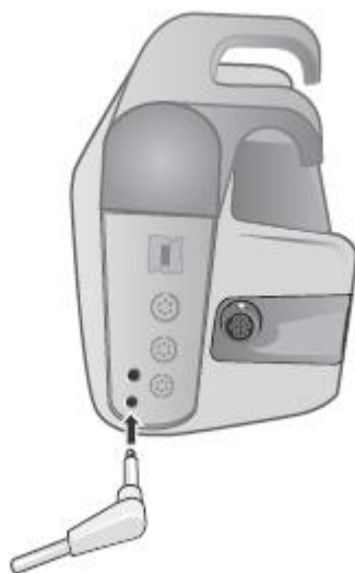
Рисунок 12-1 Подсоединение датчика температуры к прибору X Series
