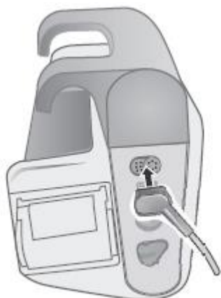
Рисунок 14-2 Подключение кабеля ЭКГ на 12 отведений
