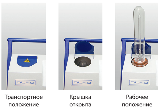
Рисунок 12. Положение лампы в корпусе установки
