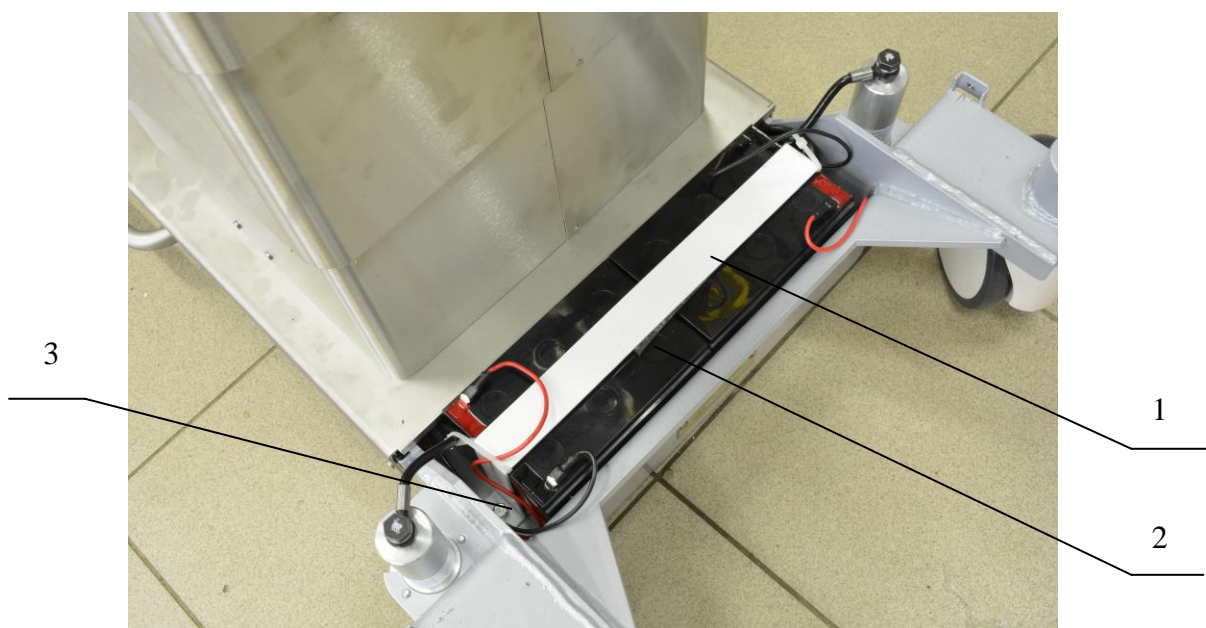
Рисунок 20 Замена аккумуляторных батарей.
