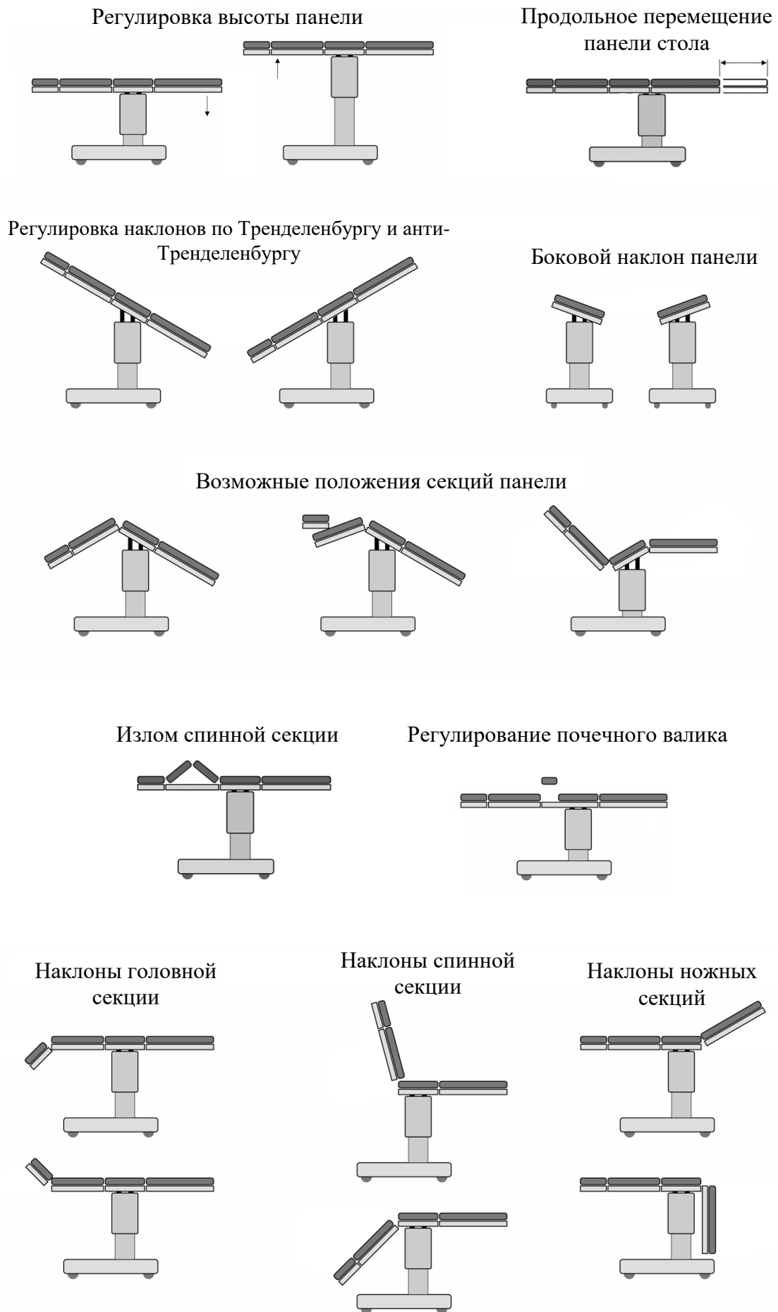
Рисунок 12. Схема регулируемых положений стола. (Значения регулируемых параметров указаны в основных технических данных).
