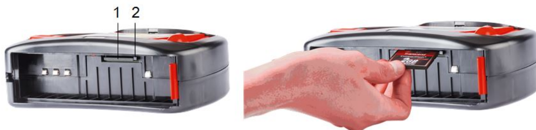
Рис. 8: Установка / замена карты памяти SaveCard
