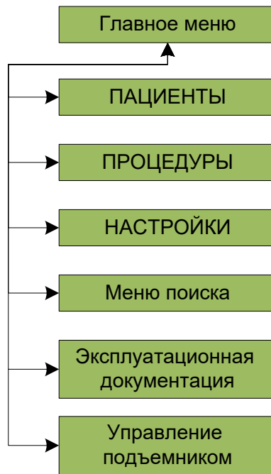
Рисунок 13 – Структурная схема меню управления аппаратом «Авантрон М»
