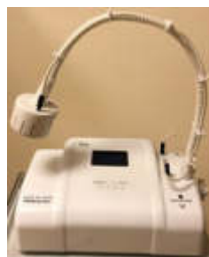
Рисунок 12 Установка индуктора на электрододержатель.
