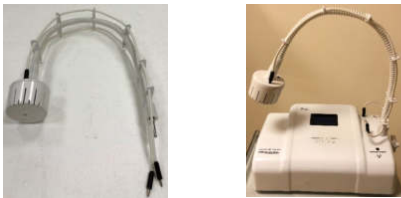
Рисунок 5 Крепление кабеля соединительного на электрододержателе
