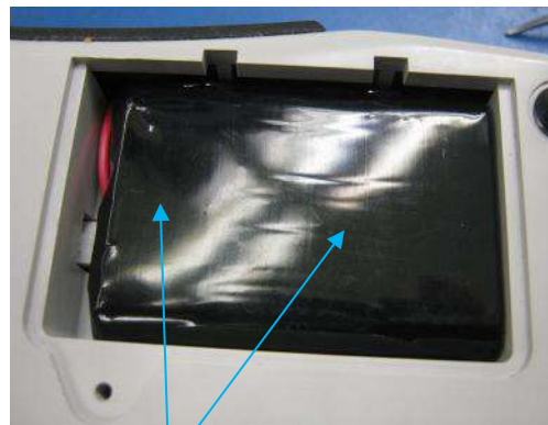
Убедитесь, что над аккумулятором нет проводов
