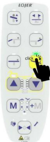
Рисунок 16: а) кнопка настройки положения Тренделенбурга на пульте управления б) кнопки движения
