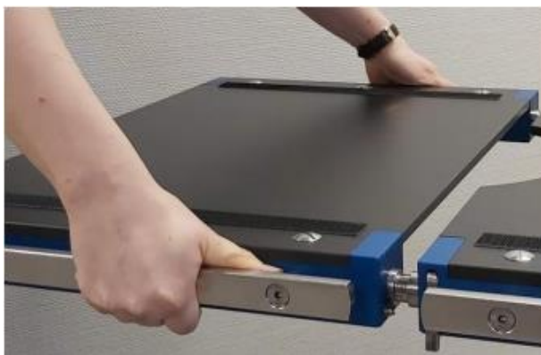
Рисунок 21: Закрепление секции стола
