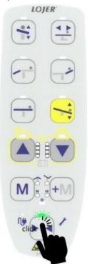
Рисунок 17: а) кнопка настройки нулевого положения на пульте управления б) кнопки движения
