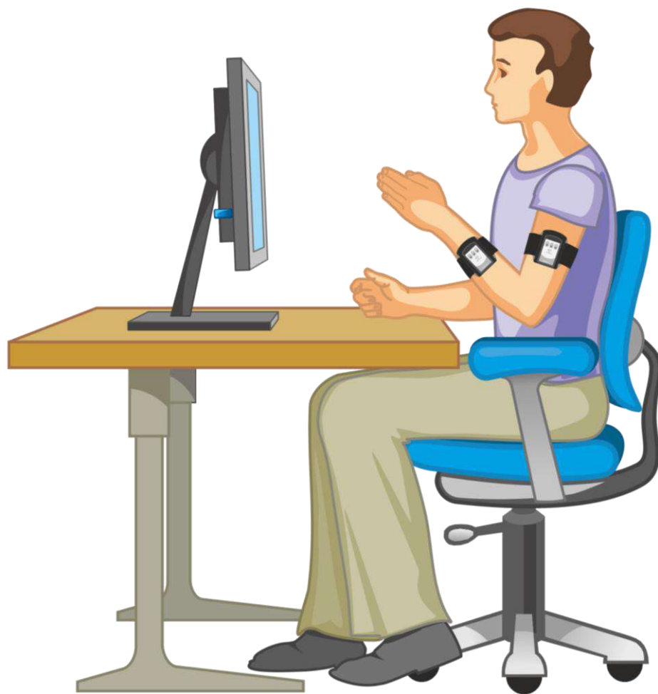
Рисунок 8 – Расположение пациента в процессе занятий с комплексом и трехмерные сенсоры
