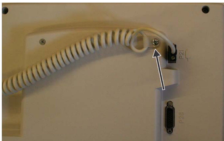
Рисунок 15 — 33. Для подключения кабеля ручного переключателя к панели блока управления дисплеем используйте зажим.
