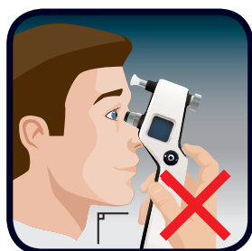
Неправильное положение тонометра и красная световая индикация на держателе датчика.
