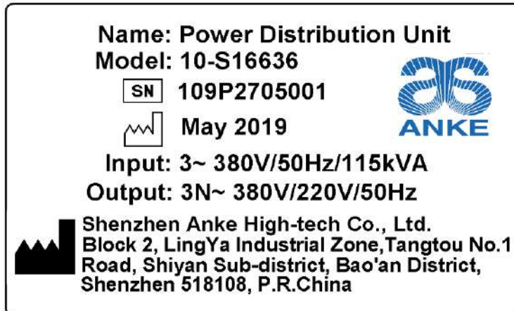
Рисунок - 11 Маркировка распределительного щита питания
