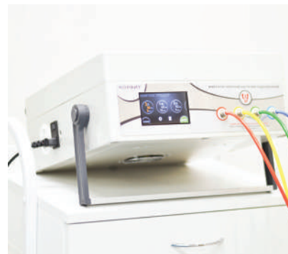
Блок управления имитатора опорной нагрузки подошвенного и пневмопровода
