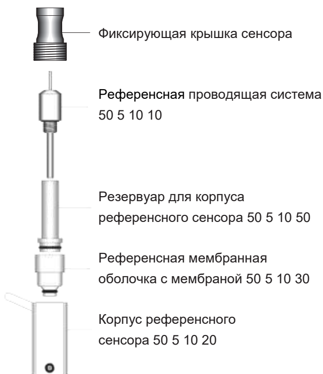
Рисунок 38 Референсный сенсор в разобранном виде (50 5 10 00)
