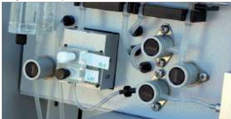
Рисунок 23 Измерительный биосенсорный модуль
