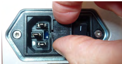
Рис. 6-10 Разъем для подключения источника питания, держатель сетевого предохранителя, включатель/выключатель
