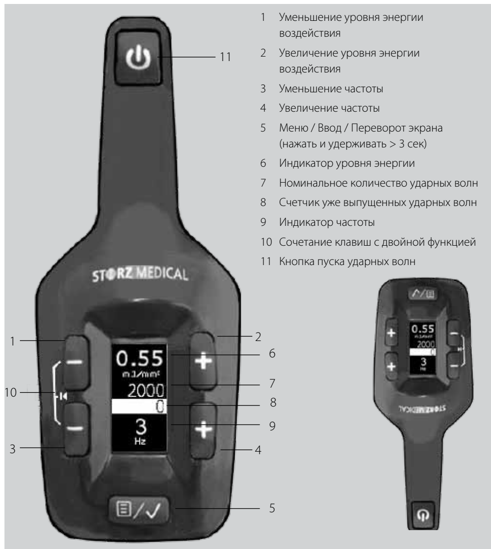
Рис. 4-2 Дисплей и клавиши настройки параметров аппликатора F-SW SEPIA
