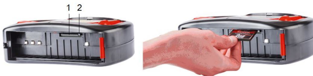
Рис. 10: Установка / замена карты памяти SaveCard
