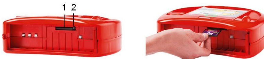
Рис. 7: Установка / замена карты памяти SaveCard
