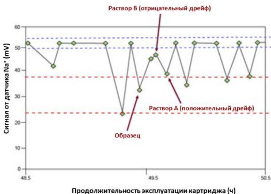
Рисунок а. Обнаружение микросгустков: Отрицательный дрейф датчика по раствору В с последующим положительным дрейфом датчика по раствору А.
