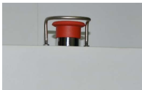
Рисунок 7. Кнопка выключения стола.
